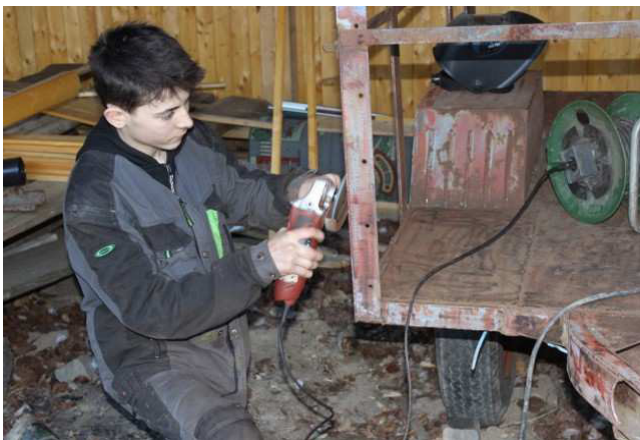
Úprava povrchu bočnic pomocí úhlové brusky
