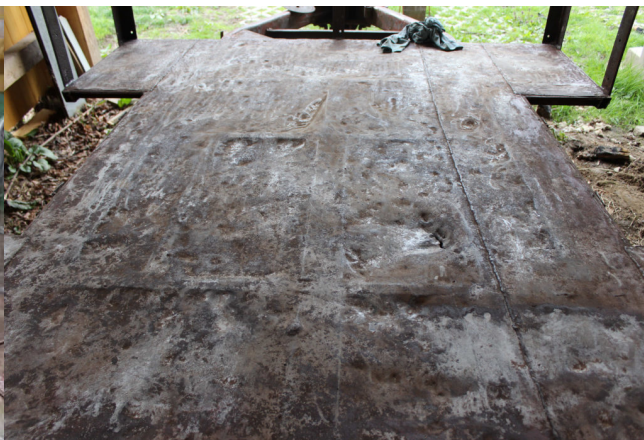
Obroušená a natřená podlaha odrezovačem
