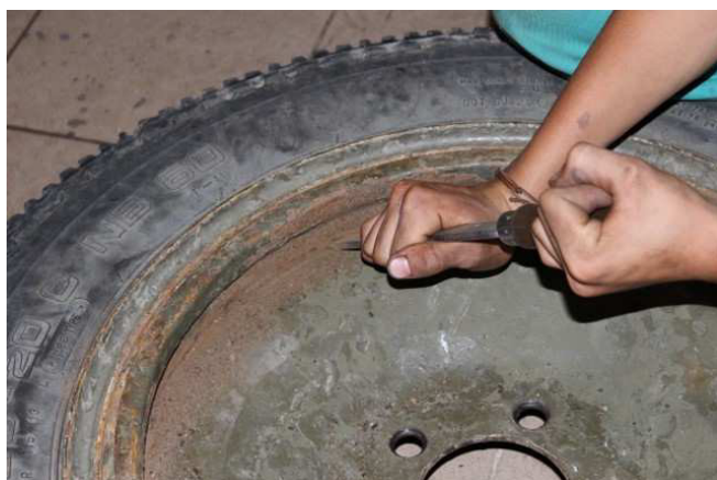
Odstranění starého nátěru pomocí škrabáku
