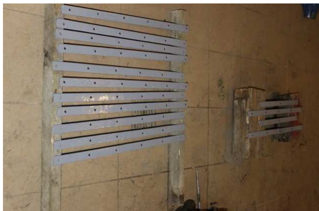
Části bočnic natřené vrchní barvou
