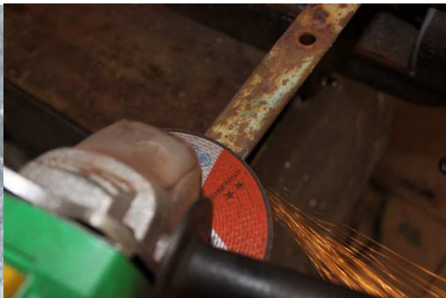
Odstranění rzi pomocí úhlové brusky
