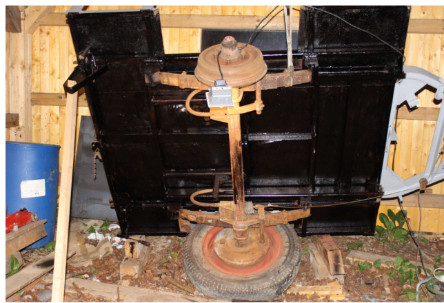
Natřený podvozek gumoasfaltem
