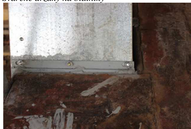
Přimontování blatníků na přivařené držáky
