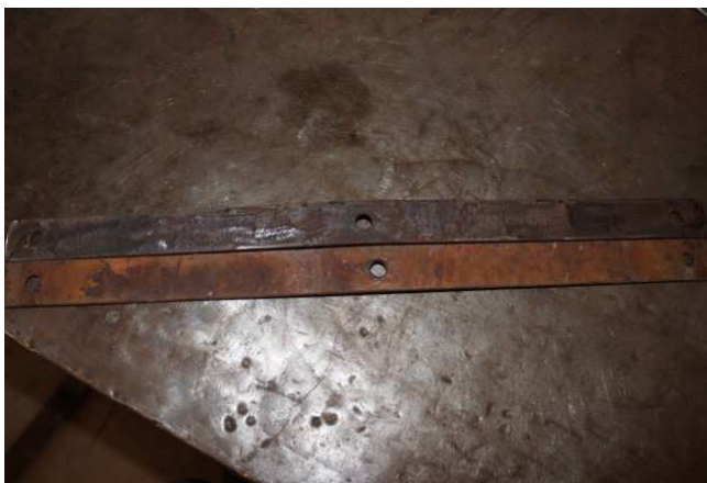
Porovnání starého kusu a kusu po úpravě odrezovačem
