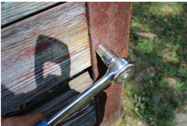
Odmontování šroubu bočnice pomocí ráčny
