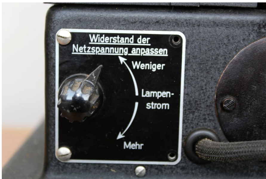
Fotografie 7: Regulace světla na projektoru Siemens
