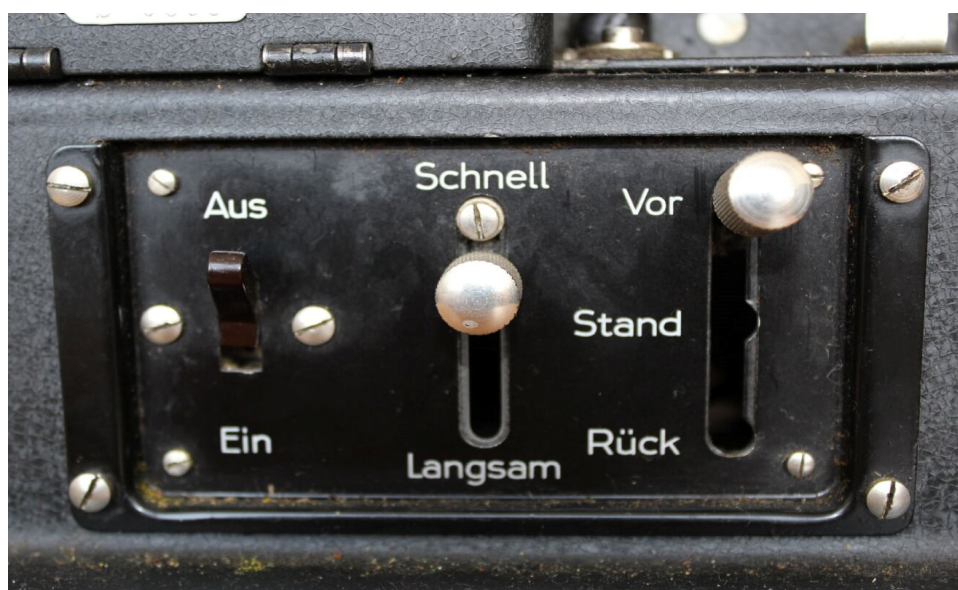
Fotografie 5: Regulace rychlosti přehrávání na projektoru Siemens
