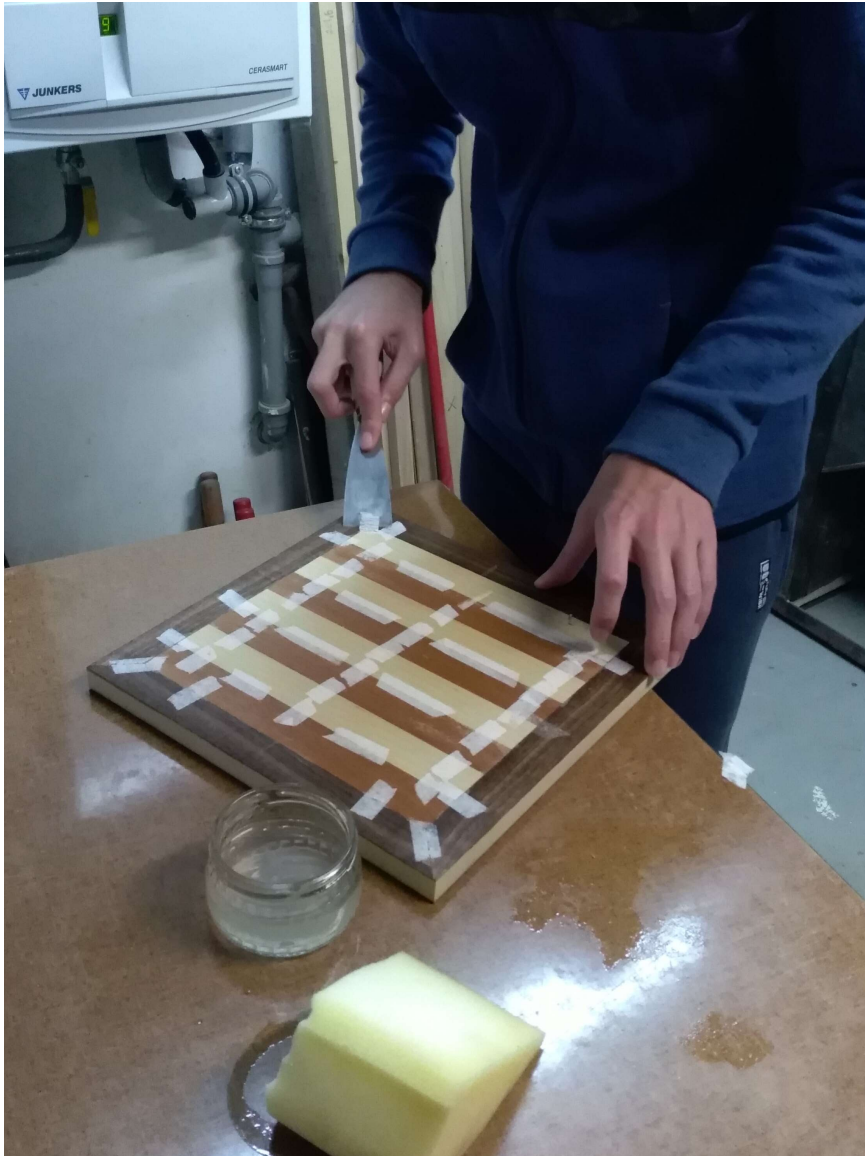
Obrázek 8: Seškrabování pásky škrabkou z levé strany šachovnice. Foto autor
