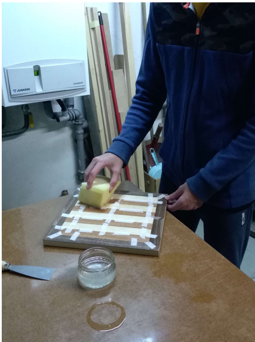
Obrázek 7: Nanášení vrstvy vody na levou stranu šachovnice. Foto autor
