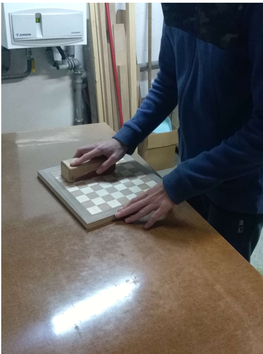
Obrázek 9: Broušení šachovnice smirkovým papírem. Foto autor
